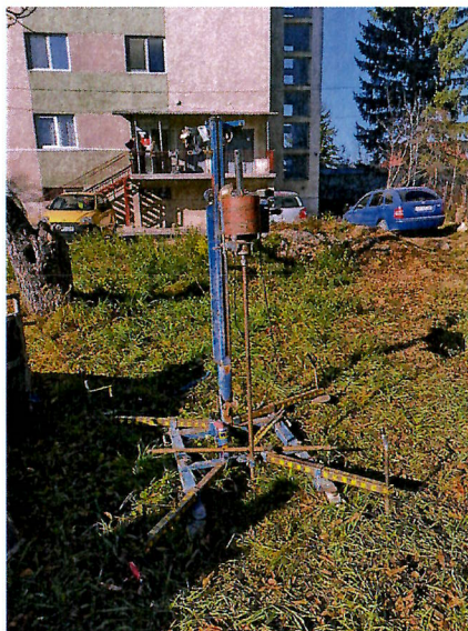
Foto.1. Penetrometrul dinamic cu con PDM utilizat
